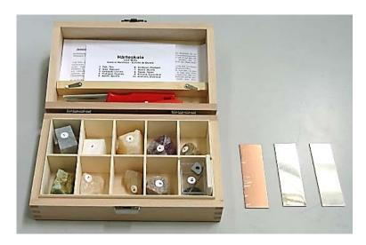
Abbildung 2.2-1 Set zur Härtebestimmung anhand der Härteskala nach Mohs
