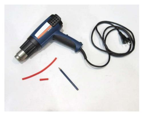
Abbildung 3.4-1 Ausrüstung und Geräte (Heißluftföhn, Schrumpfschlauch und ein Bleistift)
