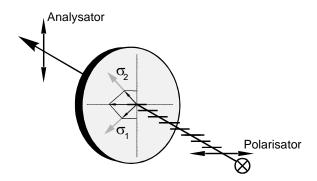
Abbildung 3.10-3 Aufteilung eines linear polarisierten Lichtstrahls in die Hauptspannungsrichtungen
