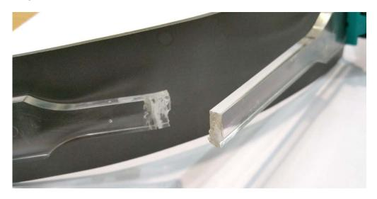
Abbildung 3.7-4 Gerissene PC-Zugprobe in Variante A, nachdem Aceton auf die Zugspannungsseite geträufelt wurde
