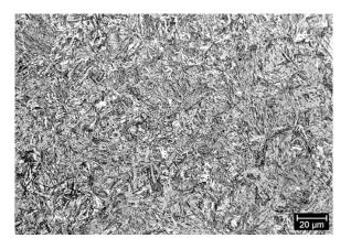
Abbildung 2.9-3: Martensit des Stahles C 45, Wärmebehandlung 1 h 850 °C, Wasserabschreckung, geätzt mit alkoh. HNO3 [Technologie der Werkstoffe, Jürgen Ruge, Helmut Wohlfahrt]
