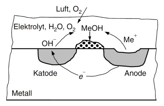
Abbildung 2.5-2: Rostvorgang (Sauerstoffkorrosion) schematisch dargestellt [Werkstofftechnik, Wolfgang Seidel]
