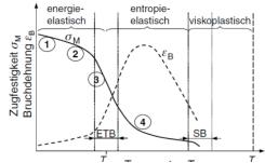
Abbildung 4.8-2 Mechanisch-thermisches Verhalten amorpher Thermoplaste, bei verschiedenen Temperaturen mit:
