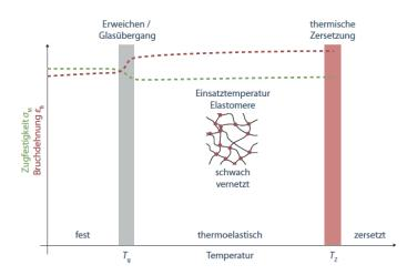
Abbildung 3.2-2 Verhalten der Zugfestigkeit über der Temperatur [Quelle: Kunststofftechnik]
