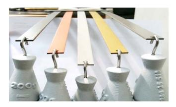
Abbildung 3.1-2 Durchbiegung verschiedener Materialien jeweils unter der Last von 200 g (v.l.n.r. Stahl, Kupfer, Aluminium, Messing und Edelstahl)
