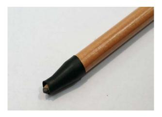
Abbildung 3.4-2 Schrumpfschlauch nach der Erwärmung an einer Bleistiftspitze
