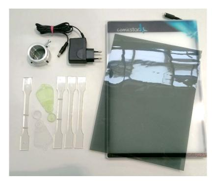
Abbildung 3.10-1: Geräte zur Visualisierung der Eigenspannungen
