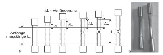
Abbildung 2.3-2 Proben beim Zugversuch, a: Probe im Verlauf eines Zugversuches, b: Proben vor und nach dem Zugversuch [Werkstofftechnik für Wirtschaftsingenieure]
