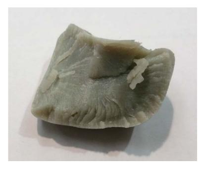
Abbildung 3.5-2 Sprödbruch des Silly Putty durch hohe Belastungsgeschwindigkeit nach einem Schlag mit dem Hammer
