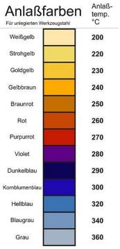
Abbildung 3.6-4 Anlassfarben für unlegierten Werkzeugstahl
