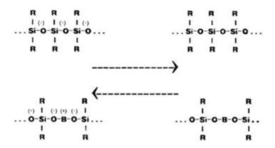
Abbildung 3.5-3: Chemische Strukturformel von Silly Putty
