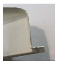
Abbildung 3.3-3 Wandstärkenunterschiede aufgrund des Thermoformens
