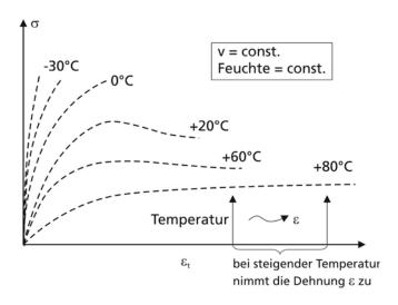
Abbildung 3.8-1 Spannungs-Dehnungsdiagramm bei verschiedenen Temperaturen [Polymer Engineering, Ritter]
