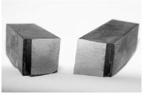
Abbildung 2.3-3 links (zäher) Verformungsbruch, rechts (spröder) Spröd- bzw. Trennbruch einer Kerbschlagbiegeprobe [Werkstofftechnik, Seidel]
