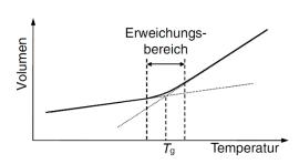
Abbildung 4.8-3 Bestimmung der Glasübergangstemperatur  $T_g$  bei Thermoplasten aus dem Volumen-Temperatur-Diagramm
