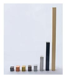
Abbildung 2.1-2 Objekte gleicher Masse und verschiedener Dichte
