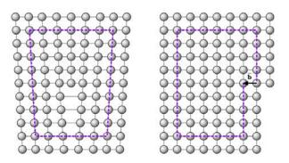
Abbildung 2.3-2 Versetzungen in der Gitterstruktur mit Burger-Vektor [Quelle Wikipedia]
