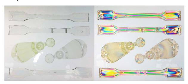
Abbildung 3.10-2 Spannungsoptik an verschiedenen Exponaten in der Anordnung eines Hellfeld-Polariskops mit linear polarisiertem licht. Links im Bild ohne Polarisationsfilter (Analysator), rechts im Bild mit Polarisationsfilter vor der Aufnahmelinse, zu sehen sind die im Bauteil eingefrorenen Eigenspannungen
