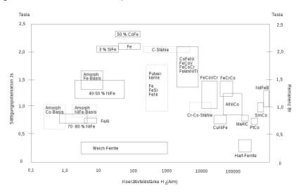
Abbildung 2.8-2 Einteilung verschiedener Magnetwerkstoffe anhand der Koerzitivfeldstärke
